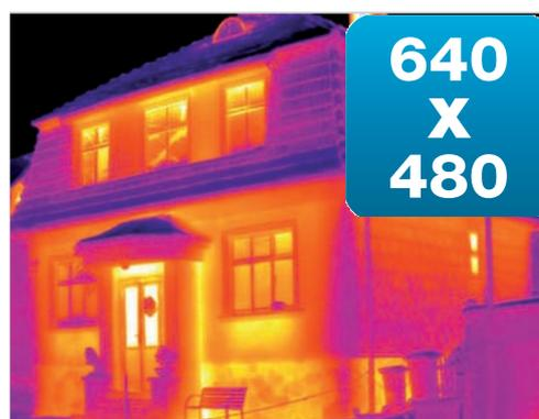
При регистрации самых незначительных перепадов температур особенно важным фактором является оптимальная температурная чувствительность (NETD). Тепловизоры Testo предлагают превосходную температурную чувствительность до < 30 мК (для модели Testo 885), которая – в комбинации с высокой разрешающей способностью – позволяет визуализировать малейшие перепады температур независимо от размеров обследуемого объекта.
