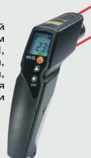
Быстродействующий и универсальный ИК-термометр с 1-точечным лазерным целеуказателем и оптикой 10:1 в эргономичном дизайне "пистолета"
