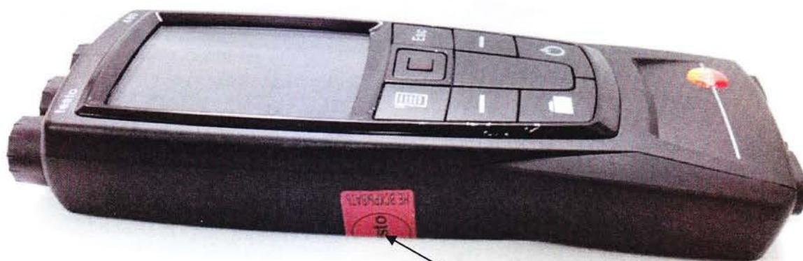
Разрушающаяся при вскрытии
