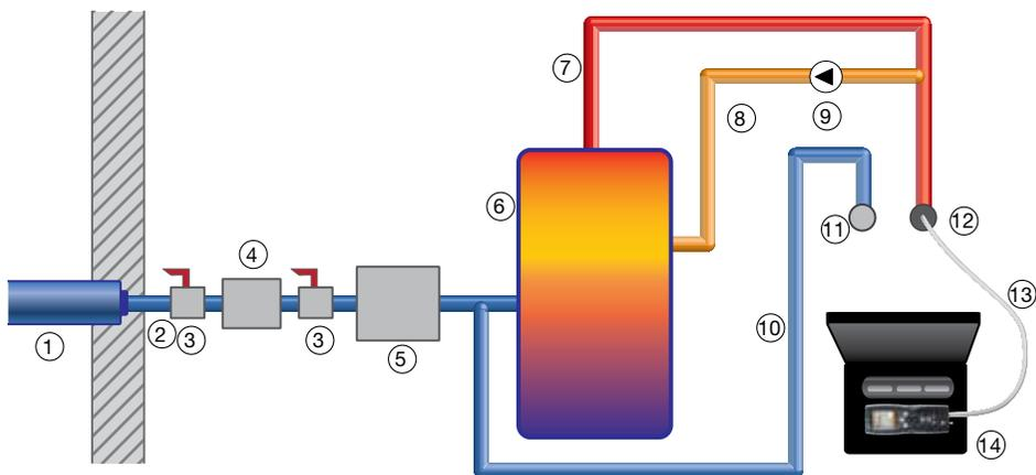
**i** Нагнетание давления осуществляется автоматически благодаря встроенному насосу testo 324. Для труб большого диаметра есть возможность подключения к трубе компрессора или дополнительного использования ручного насоса. **Обратите внимание:** максимальное давление 1 бар – при превышении срабатывает предохранительный клапан.
